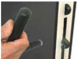
Schnelles und genaues Setup dank exzentrischen Spannschlössern. Die Zelle ist daher, im Falle von Betriebsverlagerungen, leicht zu zerlegen und wieder aufzubauen.
